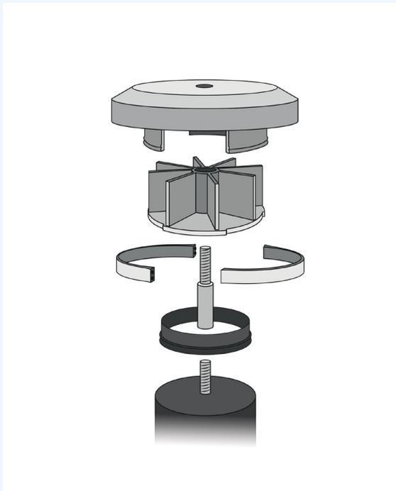
La couronne est le support des demi-bagues. Mobile, elle permet d'installer et de remplacer les demi-bagues très simplement.
